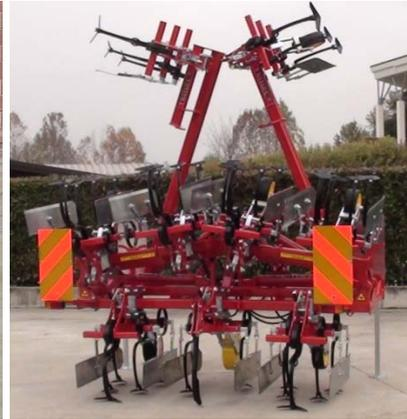
Les bineuses se composent d'un châssis principal, constitué d'une double barre horizontale à laquelle sont reliés les groupes de désherbage et de deux sections reliées par des charnières qui peuvent être repliées hydrauliquement à 180 °.
